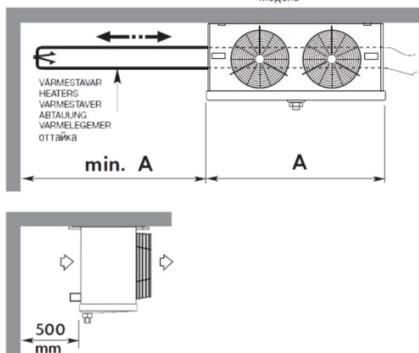
• Prima di sollevare gli apparecchi controllare l'integrità strutturale degli organi di sollevamento e il loro corretto fissaggio alla struttura (Fig. 2). È importante che l'apparecchio sia sistemato in modo da lasciare uno spazio laterale pari alla sua lunghezza. Ciò per consentire l'eventuale sostituzione delle resistenze elettriche (Fig.3).
