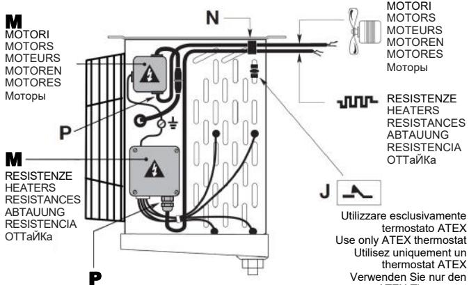
**ATTENZIONE: QUALSIASI COMPONENTE ELETTRICO NON FORNITO CON L'APPARECCHIO DEVE ESSERE INSTALLATO FUORI DALLA MACCHINA.**
