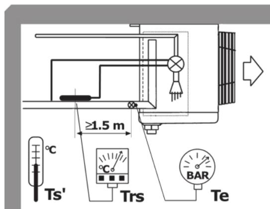
**• ATTENZIONE: all'interno del prodotto non devono essere installati componenti che possono essere causa di fughe di gas (ad esempio prese di pressione). Tutti i collegamenti frigoriferi devono essere eseguiti tramite saldobrasatura.**
