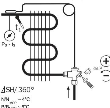
• Rimuovere l'adattatore e saldare la linea di ingresso, verificare che l'orifizio corrisponda alle specifiche, rimontare l'orifizio e l'adattatore rispettando la coppia di serraggio
