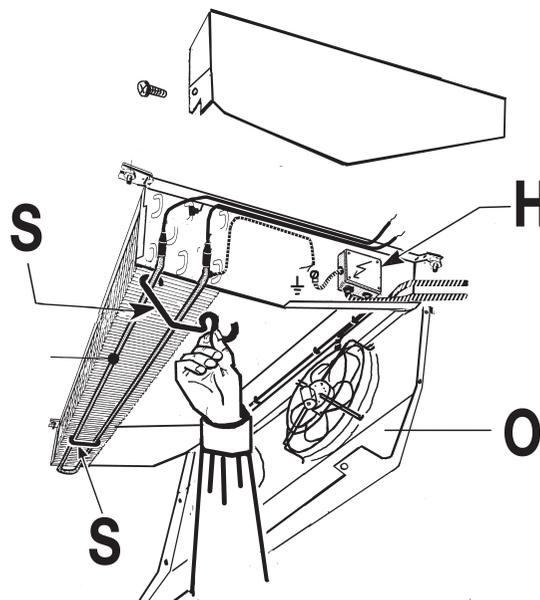
SOSTITUZIONE MOTORE / MOTOR SOSTITUTION / SOSTITUTION MOTEUR / ERSETZUNG MOTOR / SUSTITUCIÓN DEL MOTOR / ЗАМЕНА ЭЛЕКТРОДВИГАТЕЛЯ
