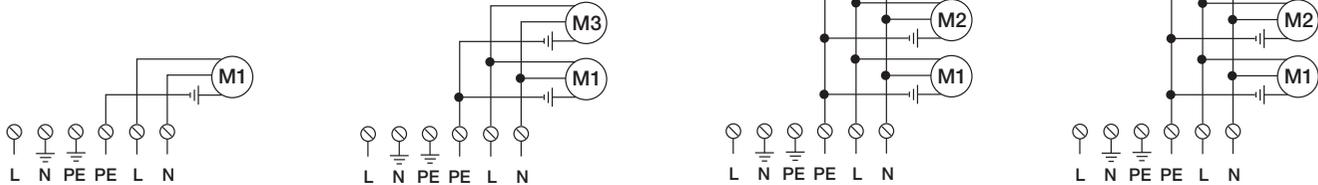
**EC - Motori elettronici a due velocità
