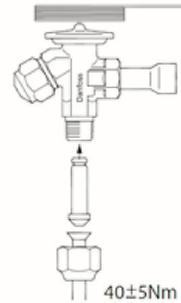
● Fissare il bulbo sul tubo di uscita in un tratto orizzontale prima dell'equalizzatore, nella posizione indicata rispettando la coppia di serraggio
